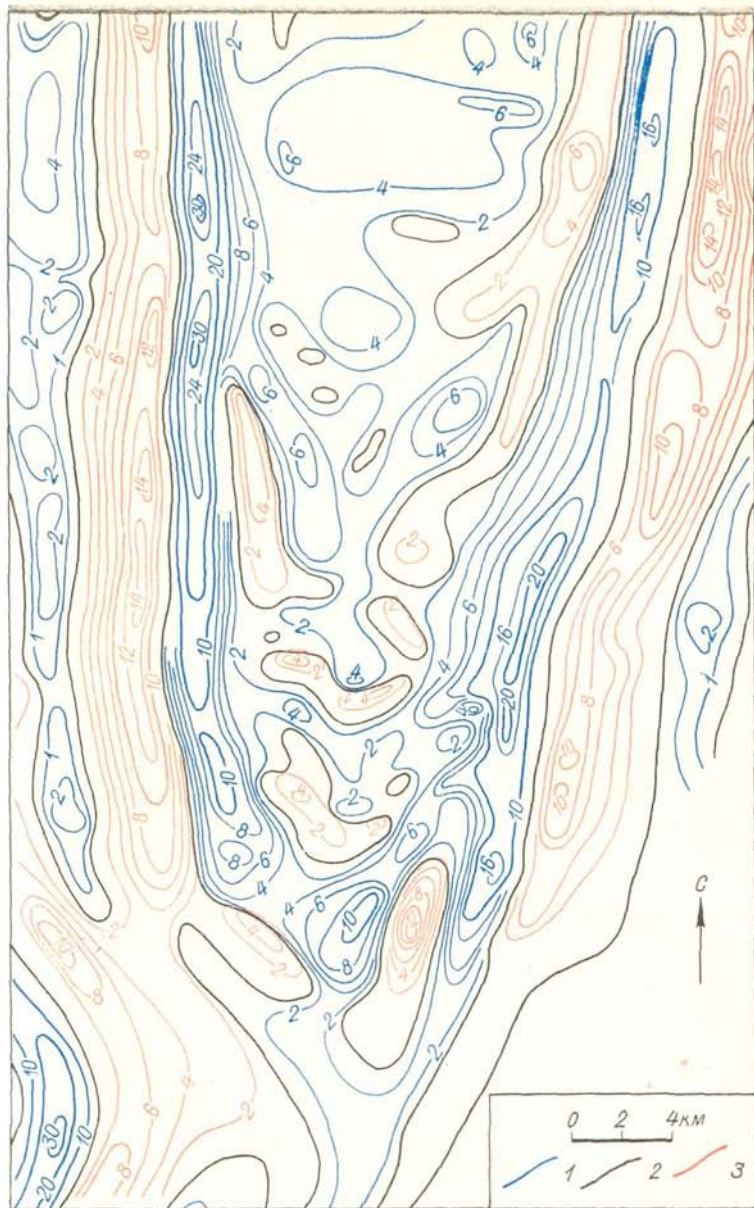
Рис. 89. Поле остаточной аномалии \Delta T над южной частью Косью-Роговской мегасинклинали (по работам Западного геофизического треста).
