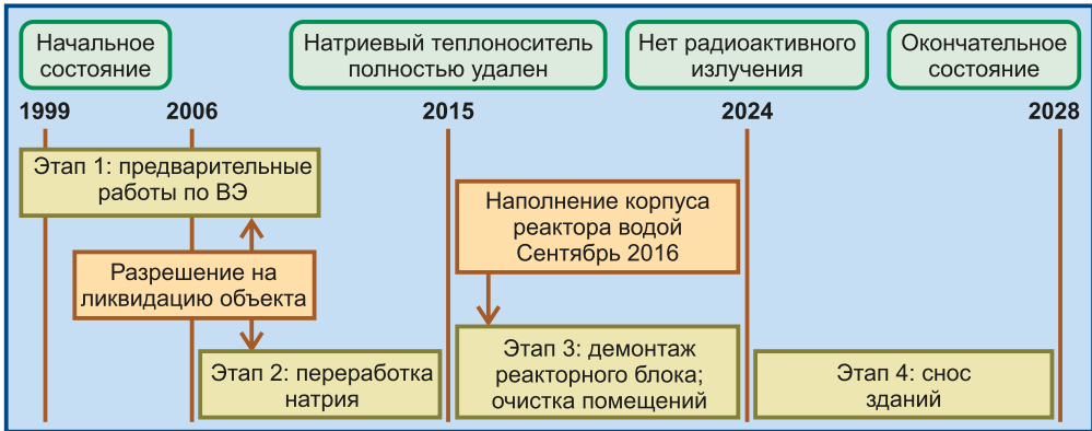
Рис. 3.25. Этапы выполнения работ по выводу из эксплуатации реактора Супер Феникс
