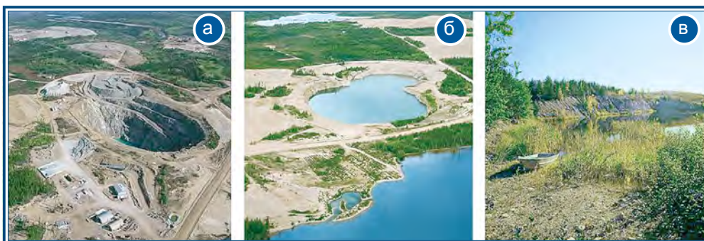
Рис. 4.24. Зона добычи урановых руд: во время эксплуатации месторождения (а); после проведения работ по выводу из эксплуатации (б) и через 20 лет после проведения работ по выводу из эксплуатации, но до озеленения территории (в)
