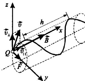
Суммарное движение будет движением по спирали, ось которой параллельна магнитному полю. Шаг винтовой линии  $h = v_{\parallel} T = vT \cos \alpha$ , где  $T = 2\pi R/v$  — период вращения частицы:
