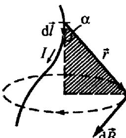
Элемент проводника  $d\vec{l}$  с током  $I$  создает в некоторой точке  $A$  индукцию поля:
