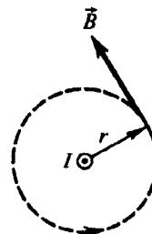
Принципиальное различие между этими формулами в том, что циркуляция вектора  $\vec{E}$  электростатического поля всегда равна нулю. Такое поле является **потенциальным**. Циркуляция вектора  $\vec{B}$  магнитного поля не равна нулю. Такое поле называется **вихревым** или **соленоидальным**.
