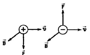
Направление силы Лоренца, так же как и силы Ампера, определяется по *правилу левой руки*. Сила Лоренца всегда перпендикулярна скорости движения заряженной частицы. Поэтому она изменяет только направление этой скорости, не изменяя ее модуля. Следовательно, сила Лоренца работы не совершает.
