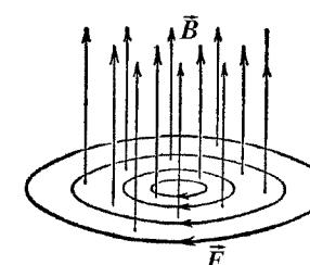
Максвелл для объяснения ЭДС индукции в неподвижных проводниках предположил, что **переменное магнитное поле возбуждает в окружающем пространстве вихревое электрическое поле**, которое и является причиной возникновения индукционного тока в проводнике.
