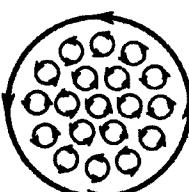
однородное внешнее магнитное поле с индукцией  $\vec{B}_0$  параллельное оси цилиндра. Если рассмотреть любое сечение цилиндра, перпендикулярное его оси, то во внутренних участках сечения магнетика молекулярные токи соседних атомов направлены навстречу друг другу и взаимно компенсируются. Нескомпенсированными будут лишь молекулярные токи, выходящие на поверхность цилиндра.
