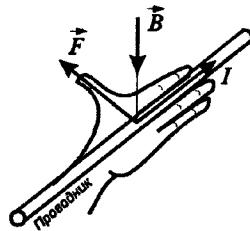
где  $dl$  — вектор по модулю равный  $dl$  и совпадающий по направлению с током,  $\vec{B}$  — вектор магнитной индукции.
