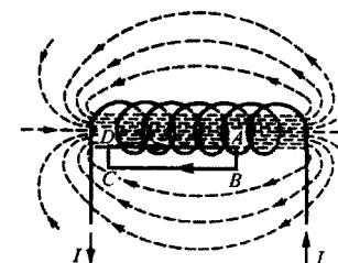
На участках  $AB$  и  $CD$  контур перпендикулярен линиям магнитной индукции, следовательно  $B_l = 0$ . Можно показать, что вне бесконечного соленоида магнитное поле  $B = 0$  (удалив участок  $CB$  на бесконечность, где магнитное поле соленоида равно нулю, поскольку магнитное поле каждого витка соленоида уменьшается с расстоянием  $\sim r^{-3}$ ). На участке  $DA$  контур совпадает с линией магнитной индукции, внутри соленоида поле однородно ( $B_l = B$ ), поэтому
