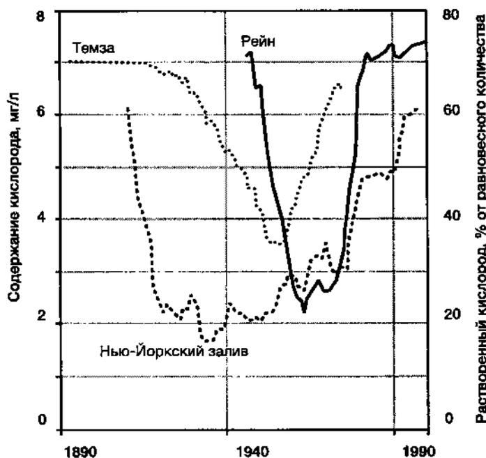
**Рис- 3.25.** Концентрация кислорода в загрязненных водах
