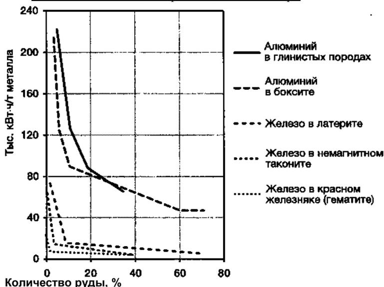
Рис. 4.7. Энергия, необходимая для производства чистого металла из руды. Чем меньше содержание металла в руде, тем больше энергии необходимо для его извлечения. (Источник: N.J. Page and S.C. Creasey.)
