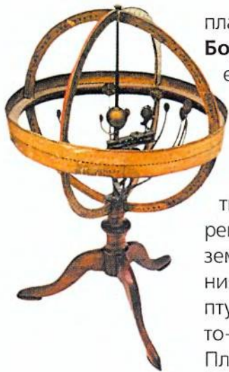
Изящный французский планетарий XVIII в. — механическая модель Солнечной системы. Сейчас словом планетарий мы называем здание, в котором ночное небо демонстрируется на куполообразном потолке
